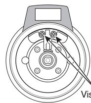
Vis de la plaque de verrouillage (2 ch.)
