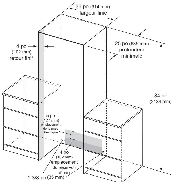
\*Un retour fini d'au moins 4 po (102 mm) qui correspond à l'extérieur de l'armoire est recommandé sur tous les côtés et le haut de l'ouverture de découpe. La zone ombragée sera visible après l'installation.
