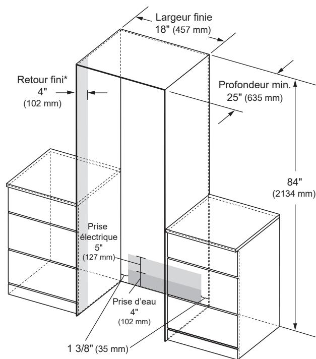
\*Un retour fini d'eau moins 4 po (102 mm) correspondant à l'extérieur de l'armoire est recommandé sur tous les côtés et le haut de l'ouverture de découpe. La zone ombragée sera visible après l'installation.
