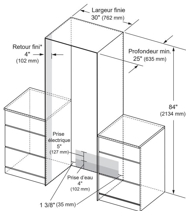
\*Un retour fini d'au moins 4 po (102 mm) correspondant à l'extérieur de l'armoire est recommandé sur tous les côtés et le haut de l'ouverture de découpe. La zone ombragée sera visible après l'installation.
